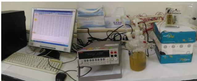
圖九、燃料電池系統組裝圖
